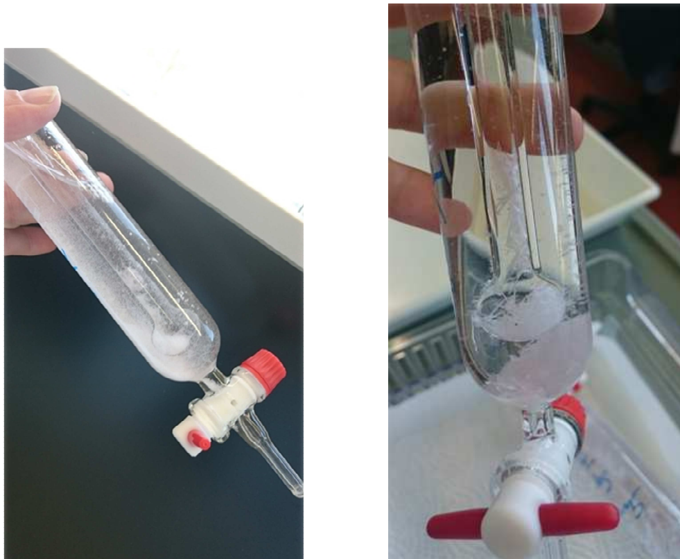
Abbildung 3: Kristallbildung im Absorptionsgefäß zur photometrischen Bestimmung bei der Analyse von Deponiesickerwasserproben.
